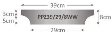
Płyta podwójnego zastosowania wkłosa wewnętrznie 39x39x8cm PPZ39/29/8WW
