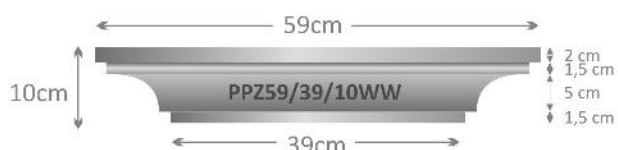
Płyta podwójnego zastosowania wkłosa wewnętrznie 59x59x10cm PPZ59/39/10WW
