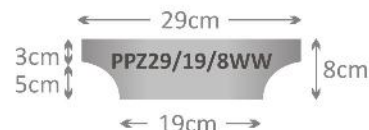
Płyta podwójnego zastosowania wkłosa wewnętrznie 29x29x8cm PPZ29/19/8WW
