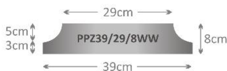
Płyta podwójnego zastosowania wkłosa wewnętrznie 39x39x8cm PPZ39/29/8WW
