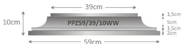
Płyta podwójnego zastosowania wkłosa wewnętrznie 59x59x10cm PPZ59/39/10WW
