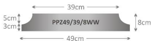
Płyta podwójnego zastosowania wkłosa wewnętrznie 49x49x8cm PPZ49/39/8WW
