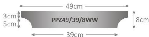
Płyta podwójnego zastosowania wkłosa wewnętrznie 49x49x8cm PPZ49/39/8WW
